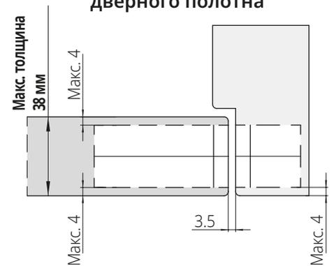
Установка петли НЕ по центру дверного полотна
