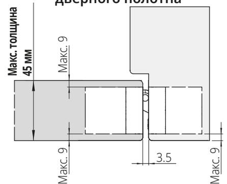
Установка петли НЕ по центру дверного полотна
