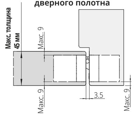
Установка петли НЕ по центру дверного полотна
