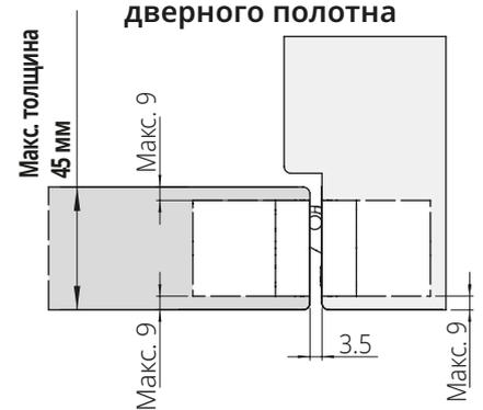
Установка петли НЕ по центру дверного полотна
